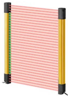
GL-VF 系列 • 最小检测物体 \varnothing 14 mm • 光轴间距 10 mm
